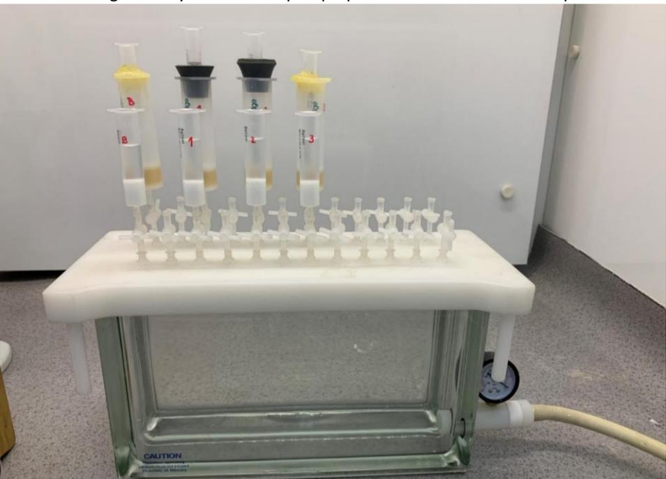
Foto 5. Extracción en fase sólida para análisis de pesticidas en muestras de agua.
