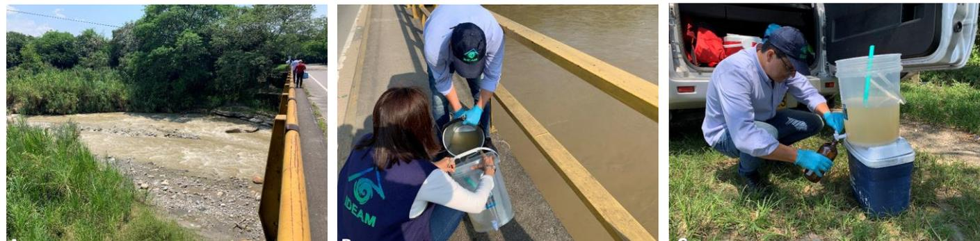
Foto 13. A) Sitio de muestreo en el río Paéz, B) Muestra de agua trasladada a un recipiente utilizado C) para dividir la muestra en diferentes botellas.
