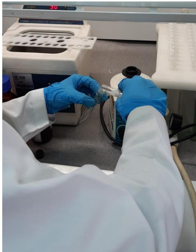
Foto 11. Transferencia del extracto del muestreador pasivo al tubo de análisis en el laboratorio del IDEAM.
