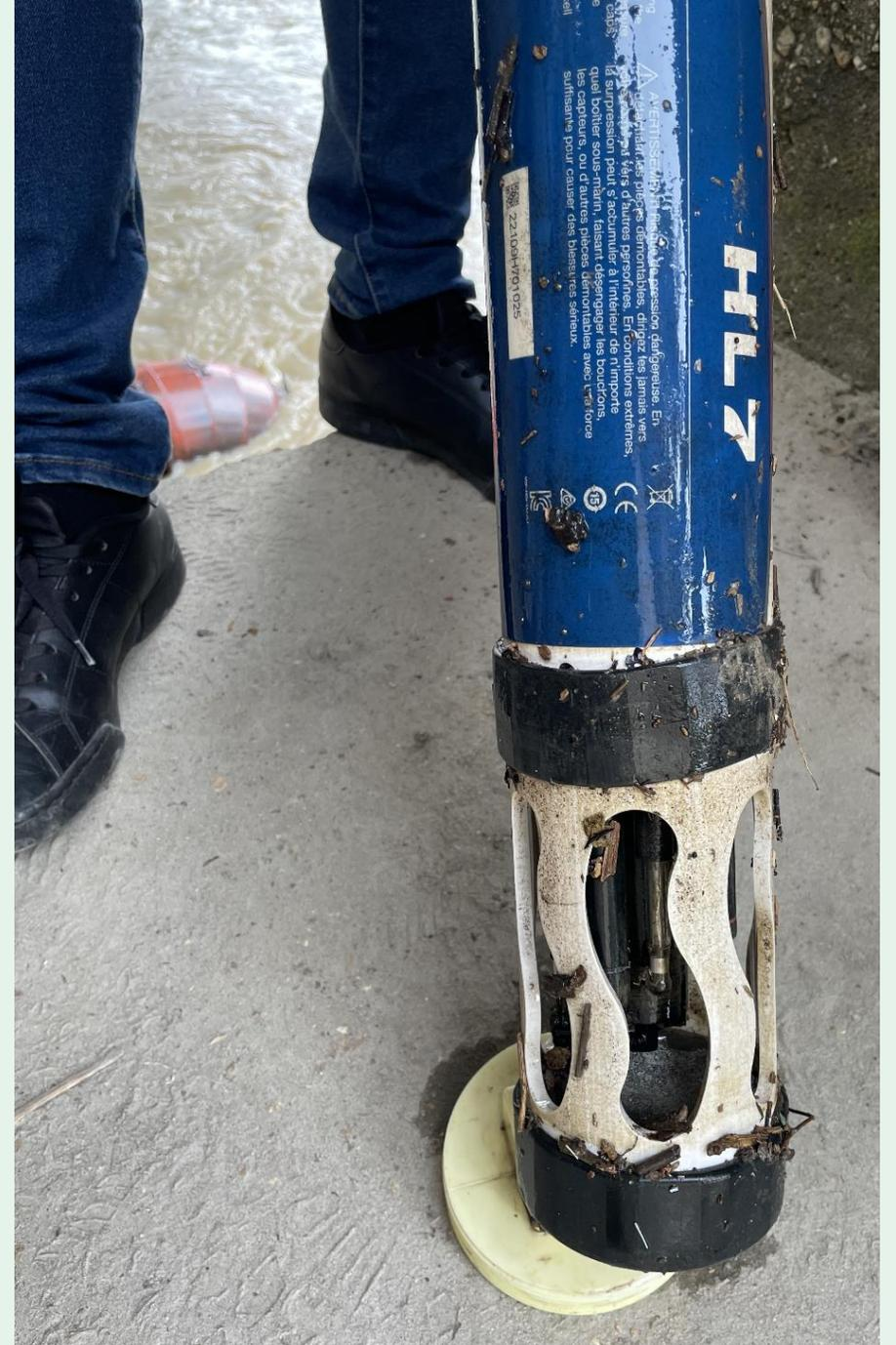
Foto 15. La sonda multiparamétrica (Hydrolab, HL7) se levantó del agua.
